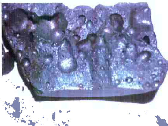
Figura 23 - Teste 3. Pelotas após o processo. Formação de porosidade
