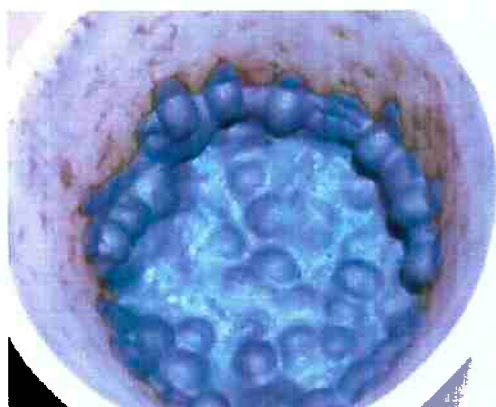
Figura 22 – Teste 3. Pelotas após o processo. Ocorreu fusão
