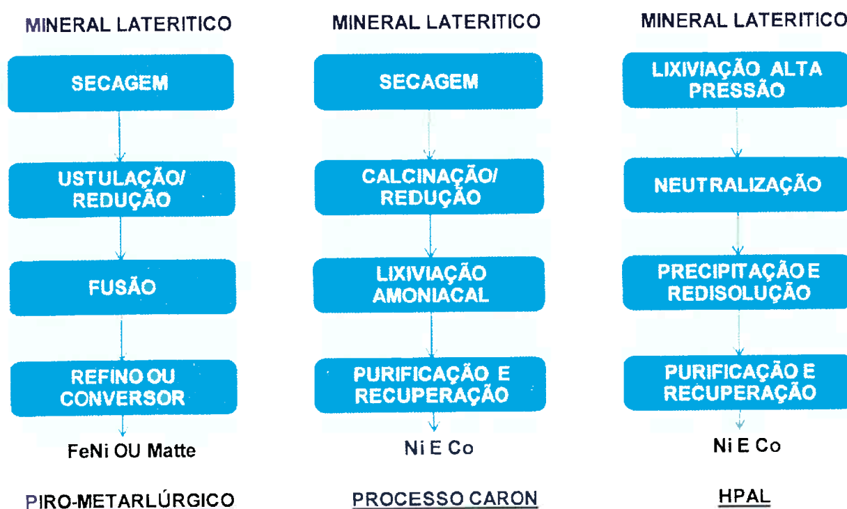
Figura 15 – Fluxograma simplificado dos processos utilizados para o minério laterítico (1)
