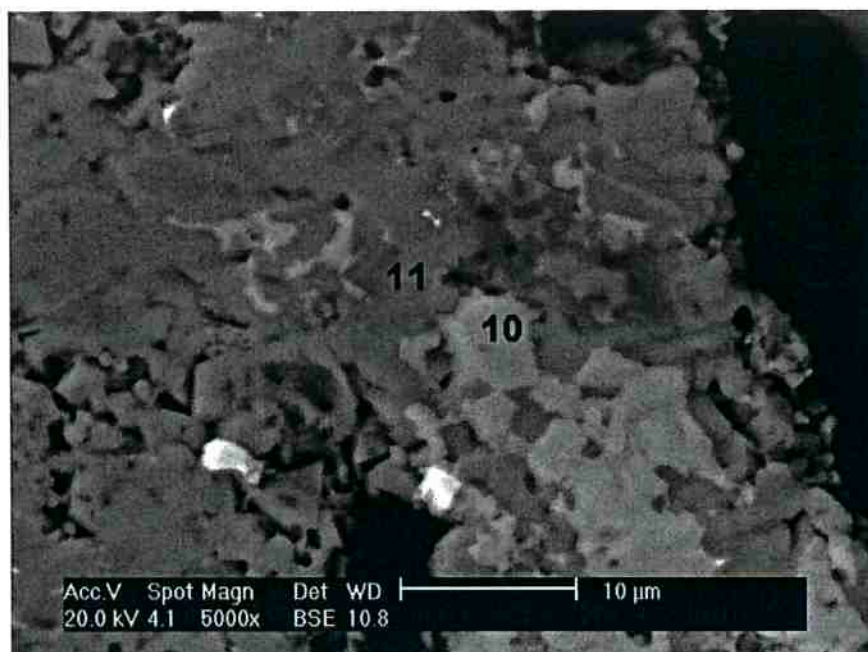
Figura 29 - Amostra 2. MEV. Minério após o processo de Thermal Upgrading. Composição: 2%C 2%S. Temperatura 1100°C. Atmosfera e resfriamento por gás N 2 . Aumento de 5000X
